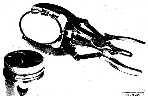
Fig. 7 Stempelringe af og på
